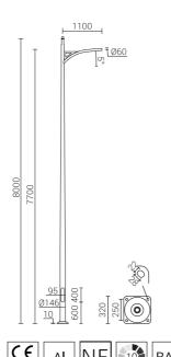
Анодирование: 10 цветов, каждый с возможностью глянца Материал: шлифованный, анодированный алюминий, с дополнительной возможностью обеспечения эластомером по цвету опоры до высоты 350 мм (другая высота по желанию клиента)
